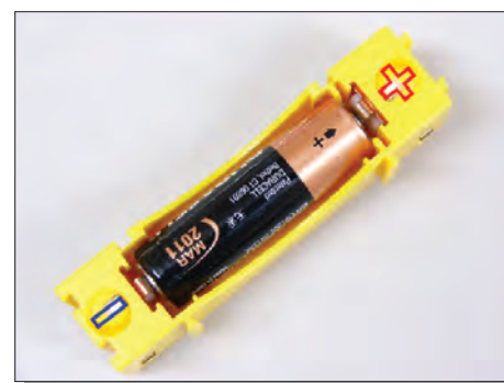
Figuur 5. Plaats de batterij in de juiste richting.
